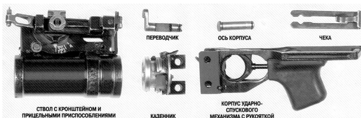
Рис. 69. Общее устройство подствольного гранатомета
