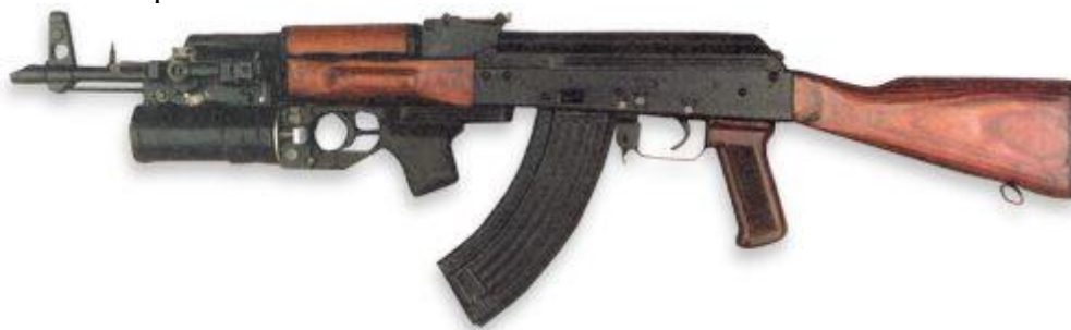
Рис. 67. Подствольный гранатомет ГП-25, присоединенный к автомату
